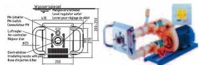
Système de nage à contre-courant Taifun avec façade rectangulaire Inox 316L, avec pompe bronze 2.6 kW, 230/400 V courant tri-phasé (entrée 3.4 kW / 5.8 ampères). Débit de 1050 litres par minute (63 m3/h) à 1 bar, GS-prooved. (Sans pièce à sceller, ni poignée)
