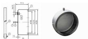
Niche en inox Ø 235 mm pour bassin carrelé, liner ou inox pour projecteur LED 12x3W et 24x3W, projecteur PAR 56 300W, halogènes 2x50W, 2x65W, 175W, 200W et 400W, et haut parleur Ø 270 mm. Bride compatible : 4060020 (inox). Demandez notre instruction d'installation N° 576924
