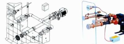
Système de massage de type STANDARD, kit complet (sauf pièces à sceller) pour piscine LINER, avec pièces apparentes en Inox 316L comprenant 2 buses de massage, 1 crépine d'aspiration 130 mm, 1 contacteur pneumatique, avec pompe bronze 0,5 kW 230V AC 25 m<sup>3</sup>/h, et un boîtier de control pneumatique.
