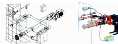
Système de massage de type STANDARD, kit complet (sauf pièces à sceller) pour bassin carrelé, avec pièces apparentes en Inox 316L comprenant 2 buses de massage, 1 crépine d'aspiration 130 mm, 1 contacteur pneumatique, avec pompe bronze 0,5 kW 230V AC 25 m<sup>3</sup>/h, et un boîtier de control pneumatique.
