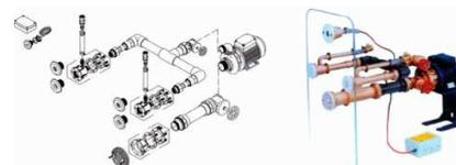
Système de massage de type STANDARD, kit complet (sauf pièces à sceller) pour piscine préfabriquée, avec pièces apparentes en Inox 316L comprenant 2 buses de massage, 1 crépine d'aspiration 130 mm, 1 contacteur pneumatique, avec pompe bronze 0,5 kW 230V AC 25 m<sup>3</sup>/h, et un boîtier de control pneumatique.
