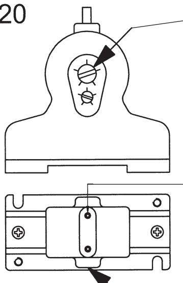
An der Regulierungsschraube des Druckwellenschalters kann der Ansprechdruck eingestellt werden.
