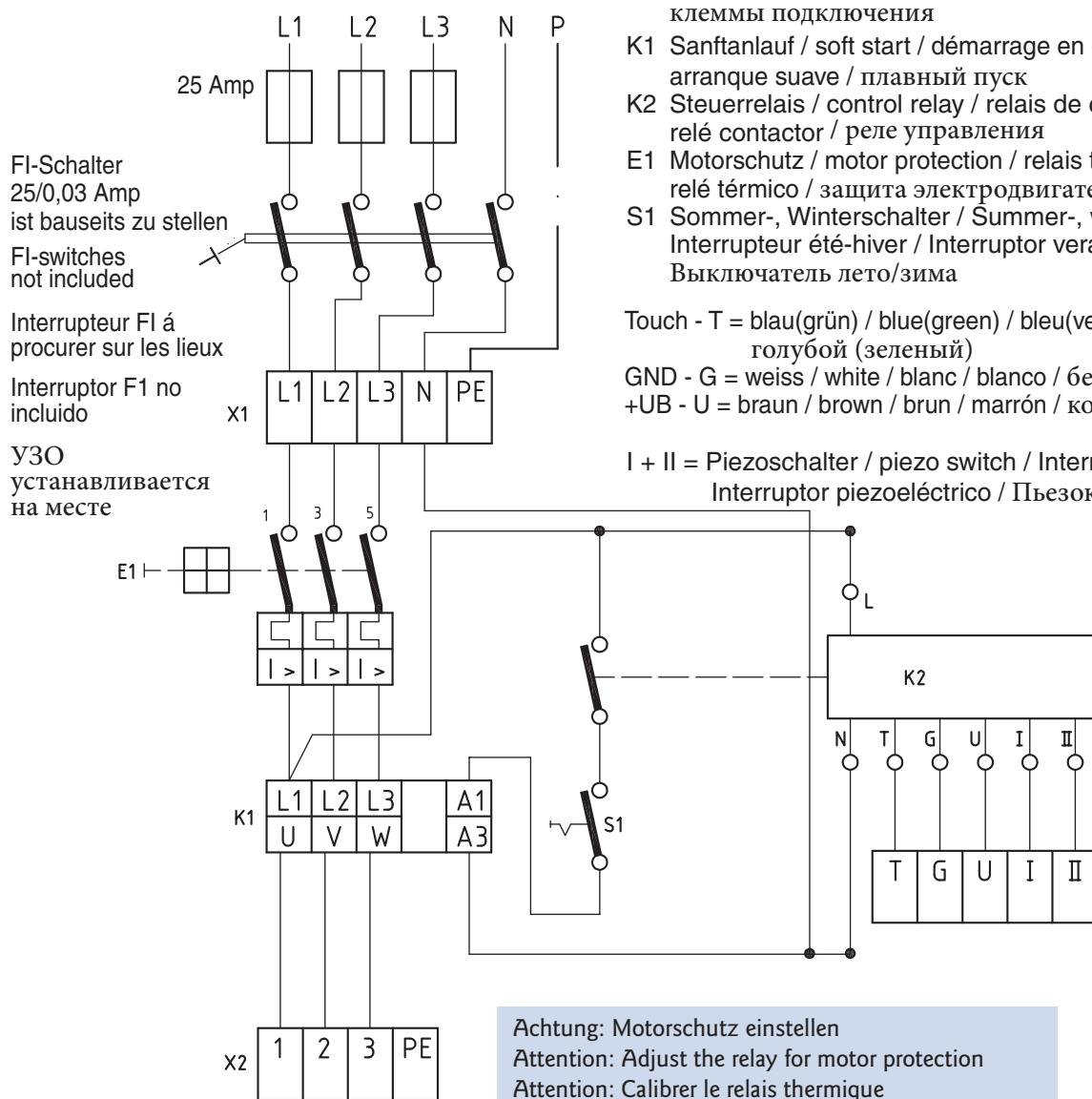
X1 Anschlussklemmen / connecting terminal / bornes de raccordement / bornes de conexión / клеммы подключения
