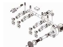
Système de massage de type STANDARD à 4 buses, kit complet (sauf pièces à sceller) pour bassin carrelé, avec pièces apparentes en Inox 316L comprenant 4 buses de massage, 1 crépine d'aspiration, 1 contacteur pneumatique, avec pompe bronze 1,5 kW 230V AC, et un boîtier de control pneumatique. Prévoir les pièces à sceller référence 8696150.
