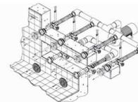
Système de massage mural KOMBI-WHIRL à 4 buses, kit complet (sauf pièces à sceller) pour bassin carrelé et liner, avec pièces apparentes en Inox 316L comprenant 4 grilles de massage, 2 crépines d'aspiration 200 mm, 1 contacteur pneumatique, avec pompe bronze 4,0 kW 230/400V AC 50 Hz mono ou triphasé 100 m<sup>3</sup>/h, et un boîtier de control pneumatique. Prévoir les pièces à sceller référence 8620050. La figure ci-contre montre l'ensemble complet, avec les pièces à sceller.
