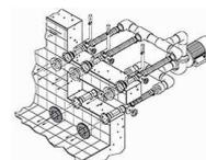
Système de massage mural KOMBI-WHIRL à 3 buses, kit complet (sauf pièces à sceller) pour bassin carrelé et liner, avec pièces apparentes en Inox 316L comprenant 3 grilles de massage, 2 crépines d'aspiration 200 mm, 1 contacteur pneumatique, avec pompe bronze 4,0 kW 230/400V AC 50 Hz mono ou triphasé 100 m<sup>3</sup>/h, et un boîtier de control pneumatique. Prévoir les pièces à sceller référence 8640050. La figure ci-contre montre l'ensemble complet, avec les pièces à sceller
